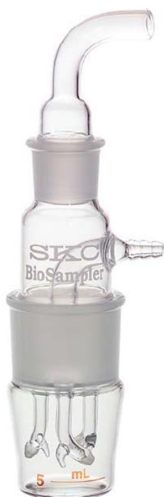
Figuur 1: Een foto van een all glass impinger met een verzamelvolume van 5 ml.
