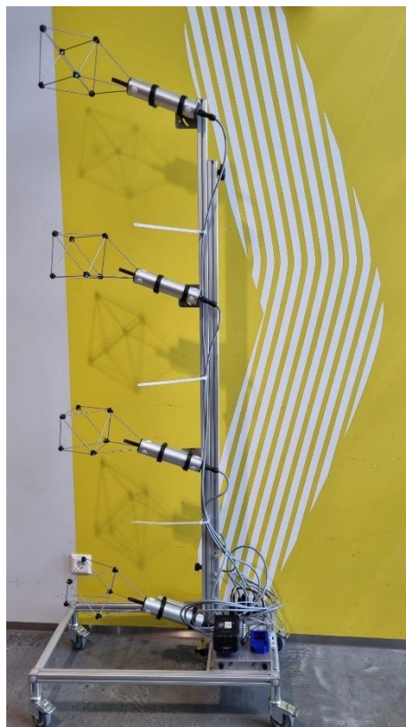
Figuur 2.3 - De mobiele meetstructuur met akoestische meetkoppen.
